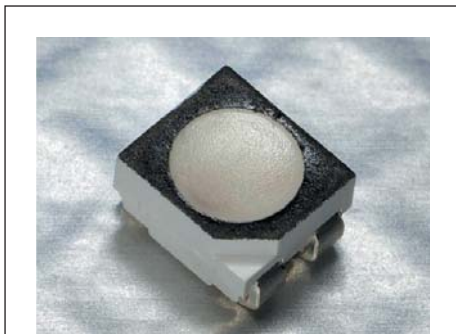
Рис. 1. Внешний вид светодиода CLV1A-FKB
