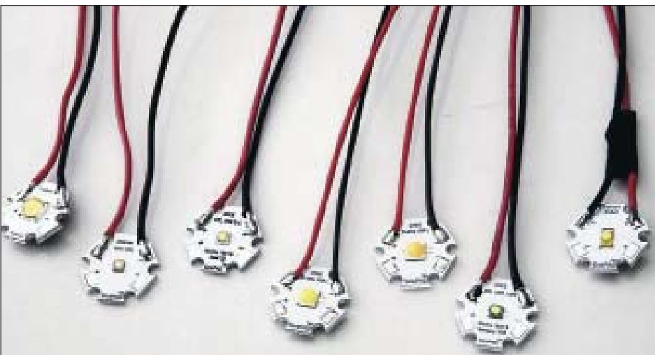
Рис. 5. Звездообразные печатные платы Sinkpad
