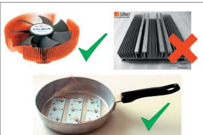
Рис. 9. Без принудительной вентиляции нет необходимости увеличивать массу и стоимость радиатора, создавая сложную развитую поверхность
