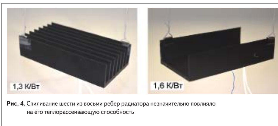
Т а б л и ц а . Изменение характеристик радиатора при спиливании шести ребер из восьми
