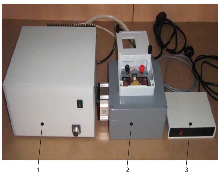
Рис. 1. Установка для измерения теплового сопротивления мощных светодиодов (УИТС): 1 — электронный блок; 2 — измерительная ячейка; 3 — буфер
