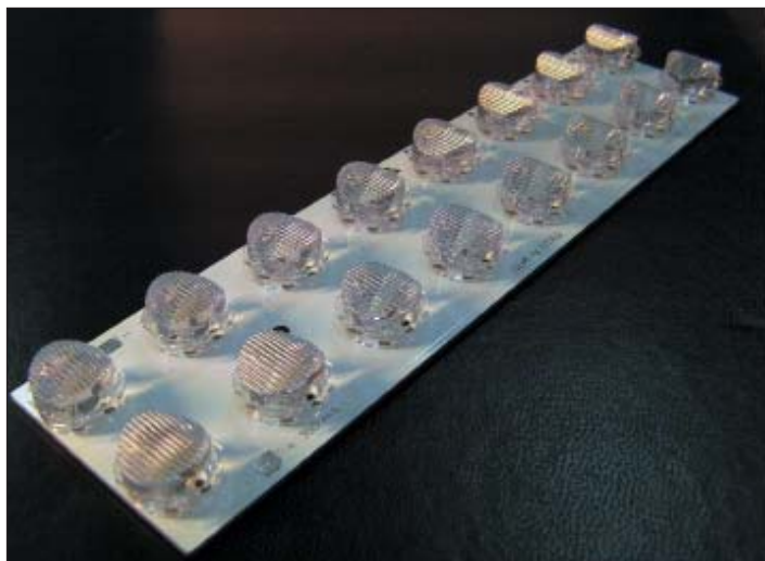
Рис. 1. Светодиодный модуль Inda Flood компании Light Engines Corporation (форм-фактор 2×8)
