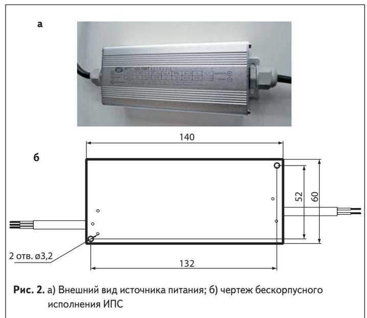
Рис. 2. а) Внешний вид источника питания; б) чертеж бескорпусного исполнения ИПС
