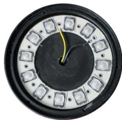
Рис. 4. Встраиваемый светодиодный модуль производства АО “KRĀSAINIE LĒJUMI”, выполненный на основе светодиодов Cree XPG Warm White (2700 K) с использованием вторичной оптики STRADA C2
