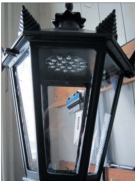
Рис. 1. Парковый светильник VECRĪGA со встроенным светодиодным модулем, выполненным на основе светодиодов Cree XPG Warm White (2700 K) с использованием вторичной оптики STRADA C2
