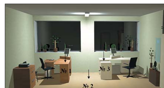
Рис. 3. Расположение контрольных точек в эксперименте при измерении горизонтальной освещенности
