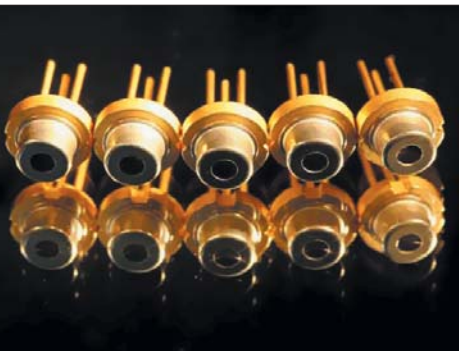
Рис. 1. Внешний вид типичных лазерных полупроводниковых излучателей, используемых в ЛЦ и дальномерах
