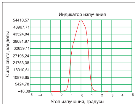
Рис. 1. Диаграмма пространственного распределения силы света прожектора WL-1 (угол подсветки 2°)
