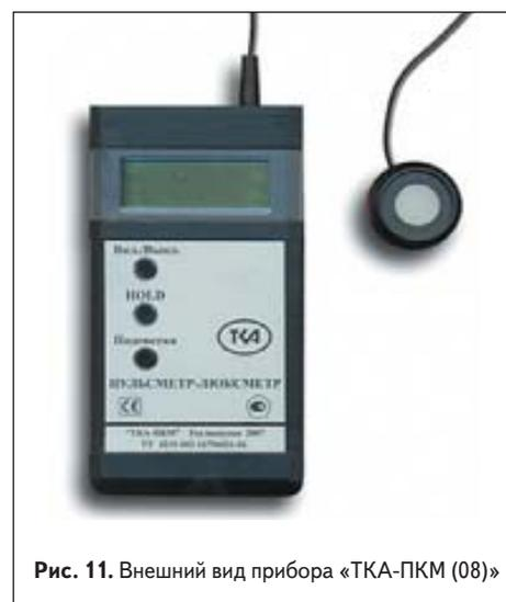
Рис. 11. Внешний вид прибора «ТКА-ПКМ (08)»
