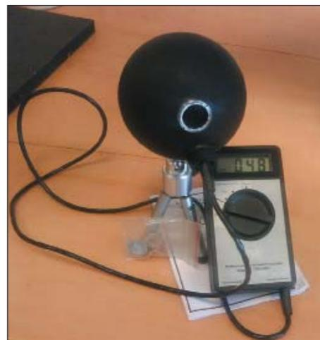
Рис. 15. Внешний вид опытного экземпляра прибора «ТКА-КК» для измерения полного светового потока излучающего светодиода
