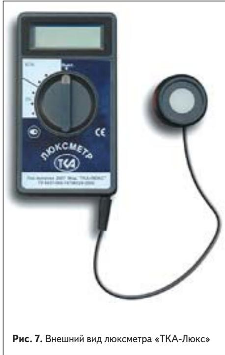
Рис. 7. Внешний вид люксметра «ТКА-Люкс»
