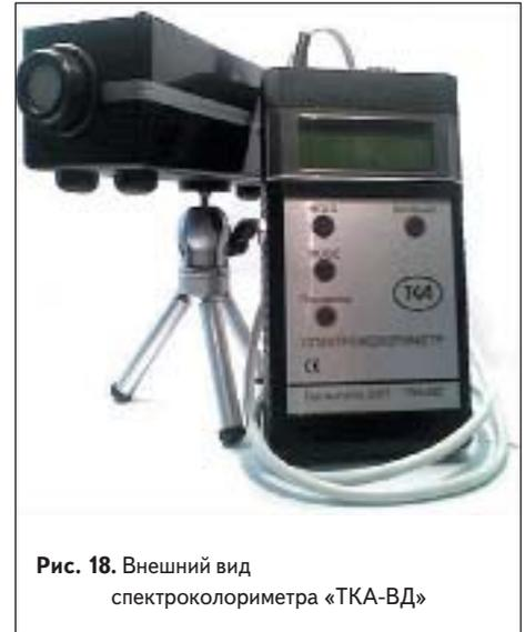
Рис. 18. Внешний вид спектроколориметра «ТКА-ВД»
