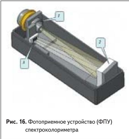
Рис. 16. Фотоприемное устройство (ФПУ) спектроколориметра
