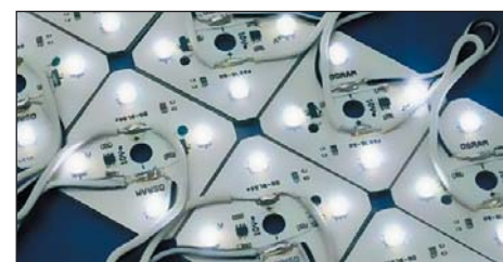
Рис. 4. Светодиодный модуль Backlight с четырьмя светодиодами на печатной плате
