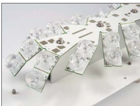
Рис. 1. Электронный модуль LED-освещения на базе технологии HSMtec
