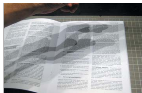
Рис. 5. Тени от светильника с 5 светодиодами MX-6, размещенными с шагом 8,9 см
