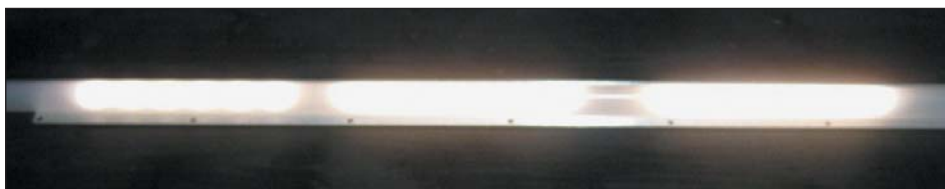
Рис. 4. Платы со светодиодами Xlamps ML-E при 150 мА с рассеивателем
