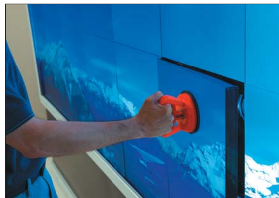
Рис. 8. Извлечение отдельного модуля MicroTiles из общего массива
