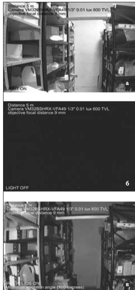
Рис. 2. Различные варианты освещения: а) обычное освещение; б) отсутствие освещения; в) освещение ИК-прожектором
