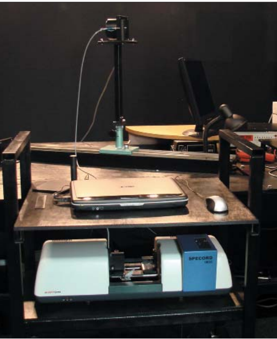
Рис. 4. Спектрометрический стенд «Спекорд» и измерение спектрального распределения излучения светильника
