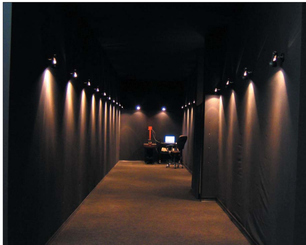
Рис. 3. Фотометрическая трасса для измерения параметров светильников. В конце коридора размещается фотометр или радиометр
