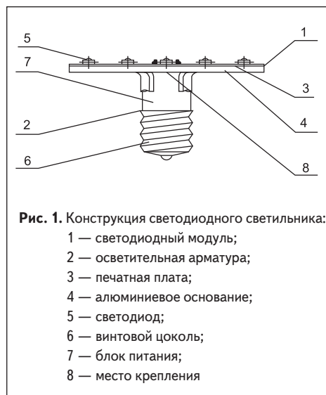
Рис. 2. Варианты устройства: 1 — светодиодный модуль; 2 — осветительная арматура; 3 — печатная плата; 4 — алюминиевое основание; 5 — светодиод; 8 — место крепления
