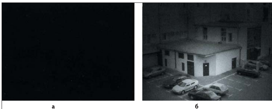
Рис. 8. Изображение, наблюдаемое при пониженных уровнях освещенности: а) в ТВ-камеру без включения ИК-осветителя IR-84; б) с включением его
