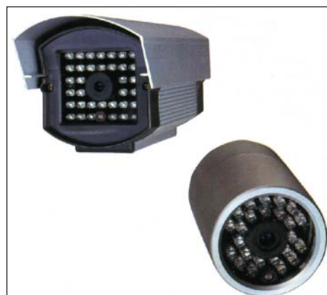
Рис. 4. ТВ-камеры НТС-71 и НТС-79 с периферическим расположением светодиодных ИК-излучателей в корпусе ТВ-камеры
