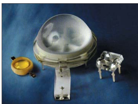
Рис. 3. Различные типы линз для формирования излучения ИК-осветителя
