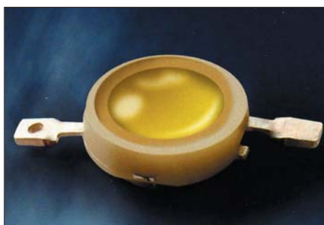
Рис. 2. Сверхъяркий светодиодный ИК-излучатель
