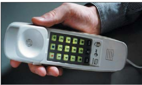
Рис. 2. Использование светодиодов на основе GaP желто-зеленого цвета свечения для освещения кнопочной панели телефона
