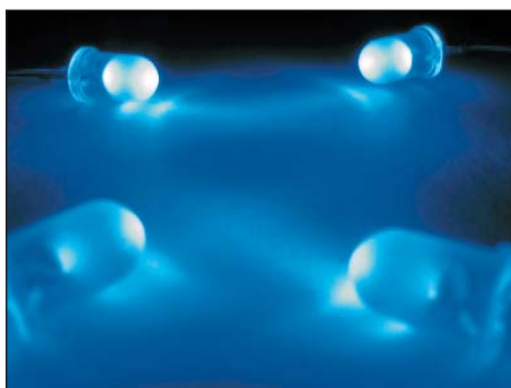
Рис. 5. Светодиоды на основе InGaN/GaN-гетероструктур голубого цвета свечения
