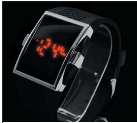
Рис. 3. Наручные электронные часы с индикаторными светодиодами на основе GaAsP красного цвета свечения
