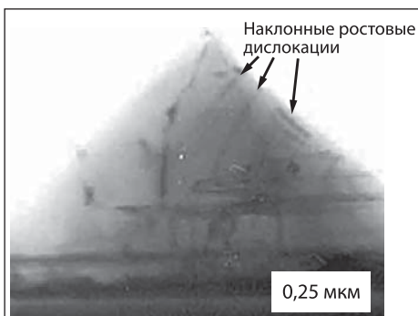
Рис. 4. Выполненная методом ТЕМ микрофотография поперечного сечения ОЗ, выращенных при низких температурах с низким соотношением V/III; РД перпендикулярны высокоиндексным граням ОЗ
