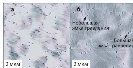
Рис. 5. Данные AFM, иллюстрирующие ямки травления в пленках GaN, выращенных: а) стандартным двухэтапным процессом; б) многоступенчатым процессом [11]. Оба скана имеют размер 10 \times 10 \text{ мкм} . Вертикальная шкала контраста для обоих изображений — 2 нм
