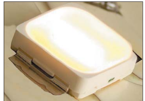
Рис. 4. Внешний вид мощного светодиода MX-3
