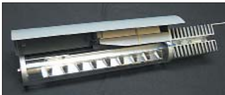
Рис. 10. Фотография светодиодного модуля мощностью 43,5 Вт
