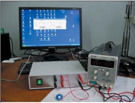
Рис. 2. Измеритель прямого падения напряжения с программой, установленной на ПК
