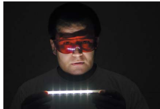
Рис. 3. Красные очки не пропускают наиболее опасную коротковолновую компоненту
