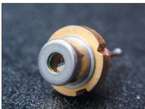
Рис. 6. Внешний вид типичного лазерного излучателя, работающего в области спектра 1550 нм
