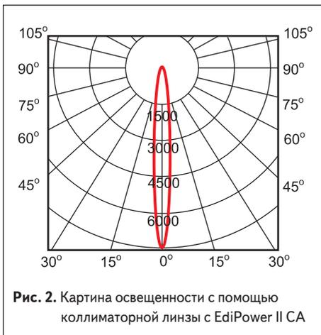
Рис. 2. Картина освещенности с помощью коллиматорной линзы с EdiPower II CA
