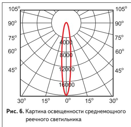
Рис. 6. Картина освещенности среднего мощного реечного светильника
