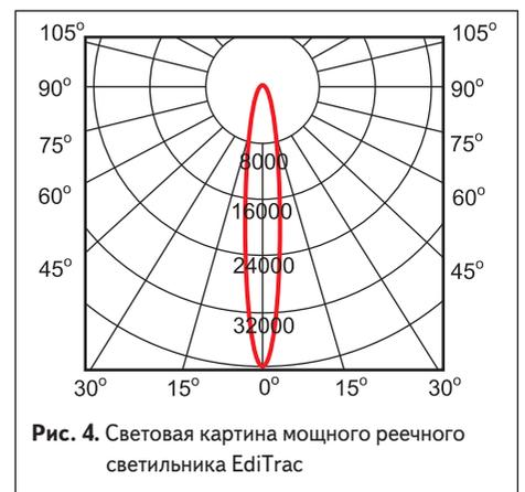
Рис. 4. Световая картина мощного речного светильника EdiTrac
