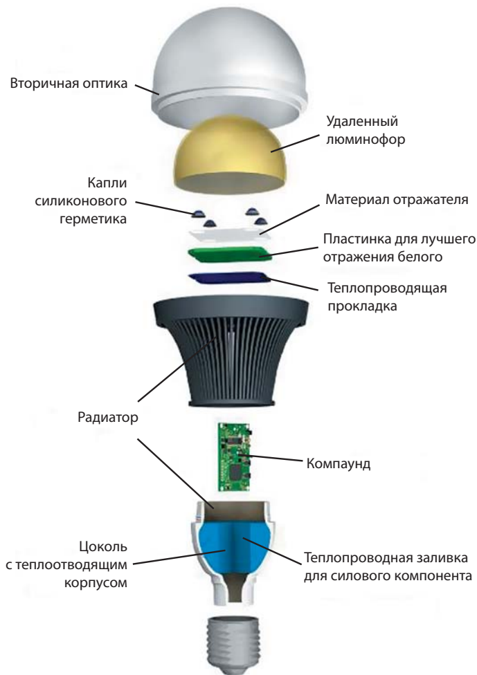
Рис. 3. Силиконовые компоненты в конструкции светодиодной лампы
