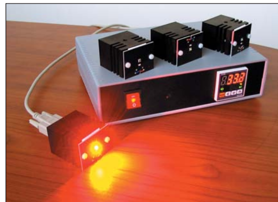
Рис. 2. Контроллер источника с подключенной светоголовкой красного цвета свечения
