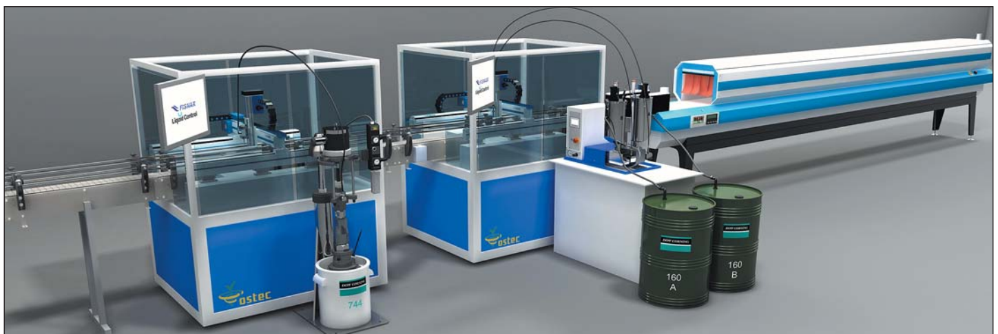
Рис. 8. Роботизированная конвейерная линия заливки и герметизации LED-светильников
