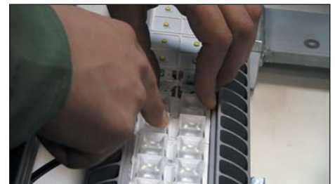
Рис. 5. Установка вторичной оптики (LEDiL). Опытные работы в лаборатории ГК Остек
