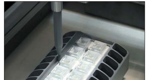
Рис. 6. Заливка светильника двухкомпонентным компаундом Dow Corning. Опытные работы в лаборатории ГК Остек
