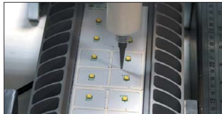
Рис. 4. Нанесение силиконового клея Dow Corning для фиксации оптики. Опытные работы в лаборатории ГК Остек
