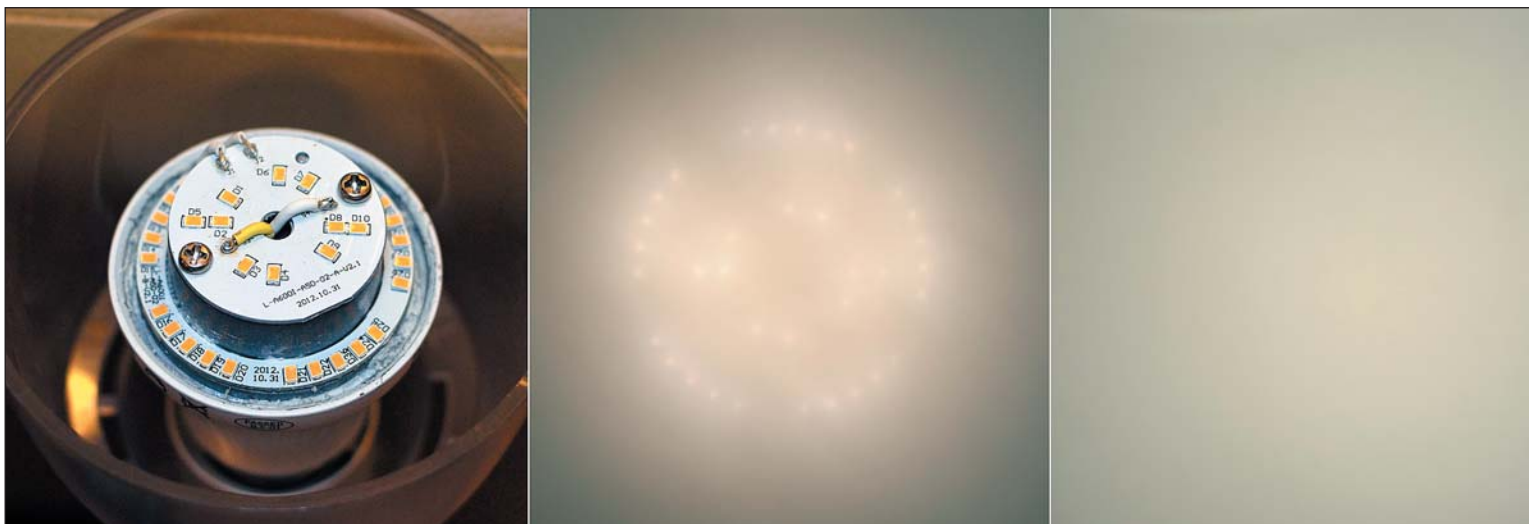
Рис. 2. Светодиодный модуль с диодами, установленными на разной высоте, и вид на этот модуль во включенном состоянии через два типа рассеивателей одинаковой толщины и одинакового внешнего вида под внешним освещением: с отражающим (по центру) и преломляющим (справа) диффузантами (для двух последних снимков геометрия сцены и настройки фотоаппарата в ручном режиме одинаковы)
