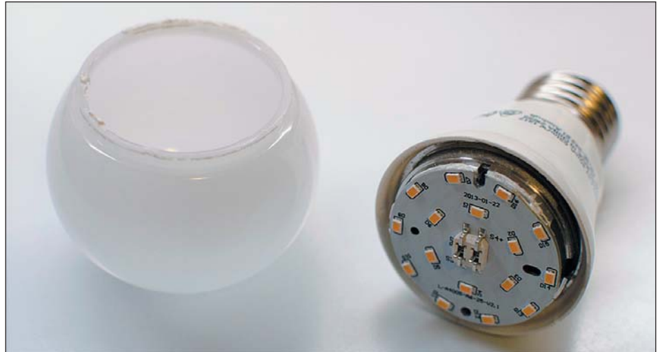
Рис. 8. КПД оптической системы этой лампы составляет 90%, что было бы невозможно при плоской форме светильника с рассеивателем той же степени матовости
