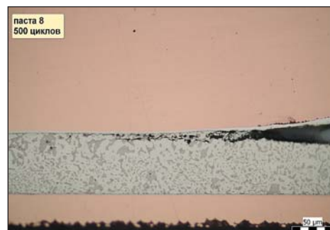
Рис. 8. Паста 8 — трещины в галтели после 500 циклов
