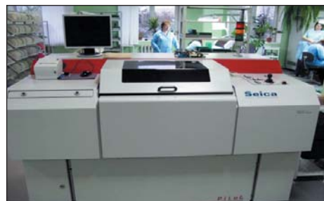
Рис. 8. Установка тестирования PILOT
