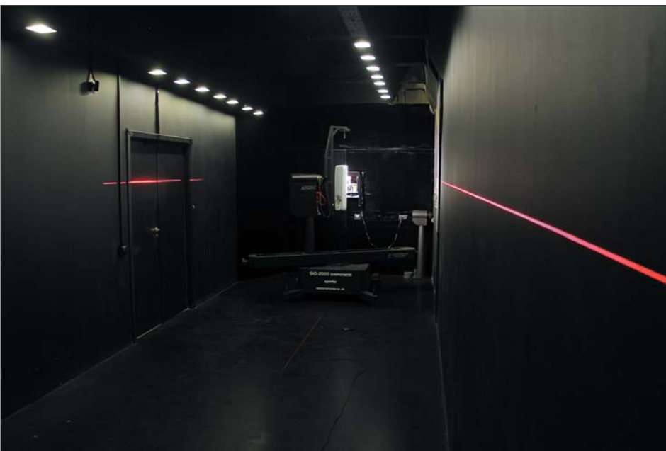
Рис. 2. Объект № 1 в процессе гониофотометрирования в лаборатории ГК «Светлана-Оптоэлектроника»
