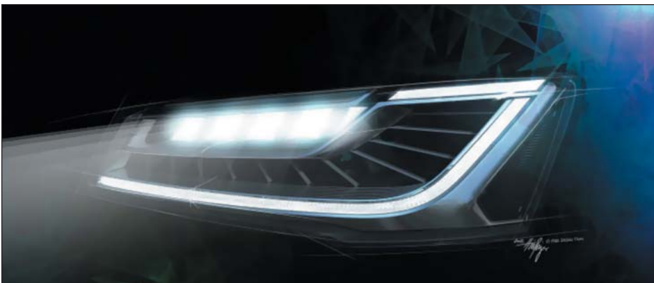
Рис. 1. Фары Audi Matrix — пример матричного светодиодного автомобильного светового прибора, который создает управляемые пучки света для улучшения видимости
