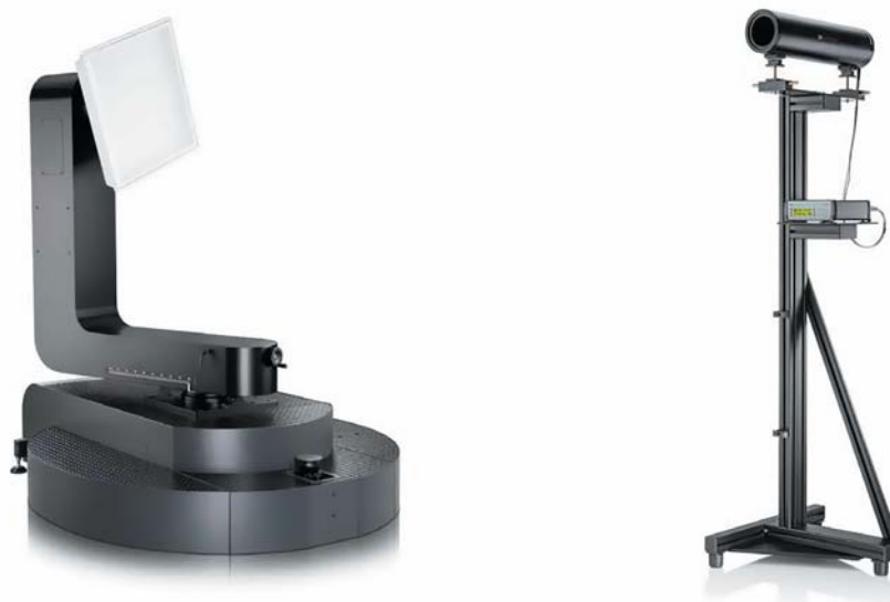
Рис. 1. Гониометр в стандартной конфигурации (слева) и детектором с тубусом на штативе (справа)
