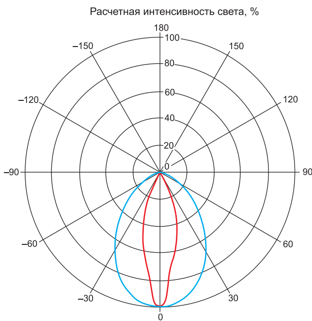
Рис. 3. а) Кривые распределения относительной интенсивности света (левая сторона) двух твердотельных источников света, использованных в данном исследовании; б) абсолютное распределение силы света светильников в С-плоскости декартовой системы координат.
