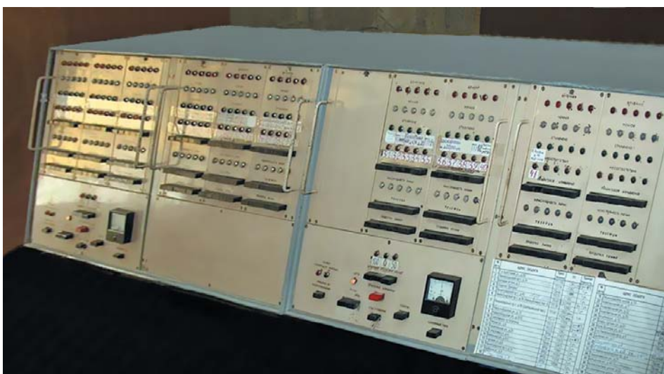
Рис. 7. Пульт управления городским освещением УТУ-4М для 50 ИП
