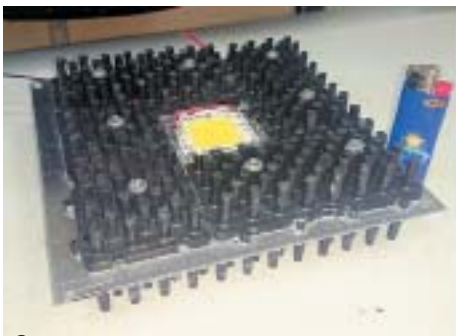
Рис. 6. а) Кластер, закрепленный на алюминиевой пластине; б) игольчатые модульные радиаторы охлаждения
