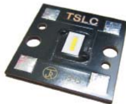
Рис. 6. Конструкция излучателя на основе множества светодиодных кристаллов новой светодиодной лампы H4/H7 компании SemiLEDs
