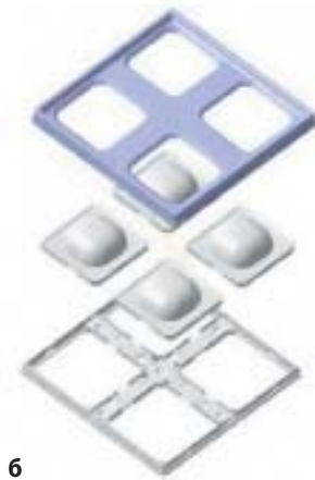
Рис. 10. Крепление линзы к радиатору при помощи: а) одиночного держателя; б) держателя 2×2
