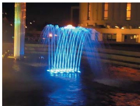
Рис. 11. Подсветка фонтана с использованием 10 СД ПП синего цвета свечения
