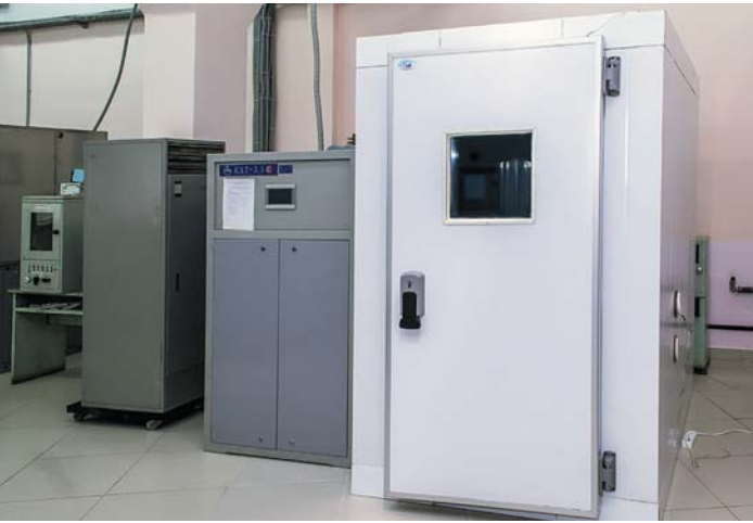
Рис. 4. Камера холода и тепла КХТ-3,5
