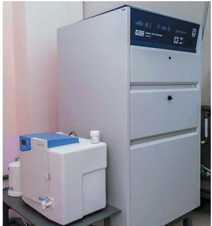
Рис. 5. Везерометр Q-SUN Xe-3-HS
