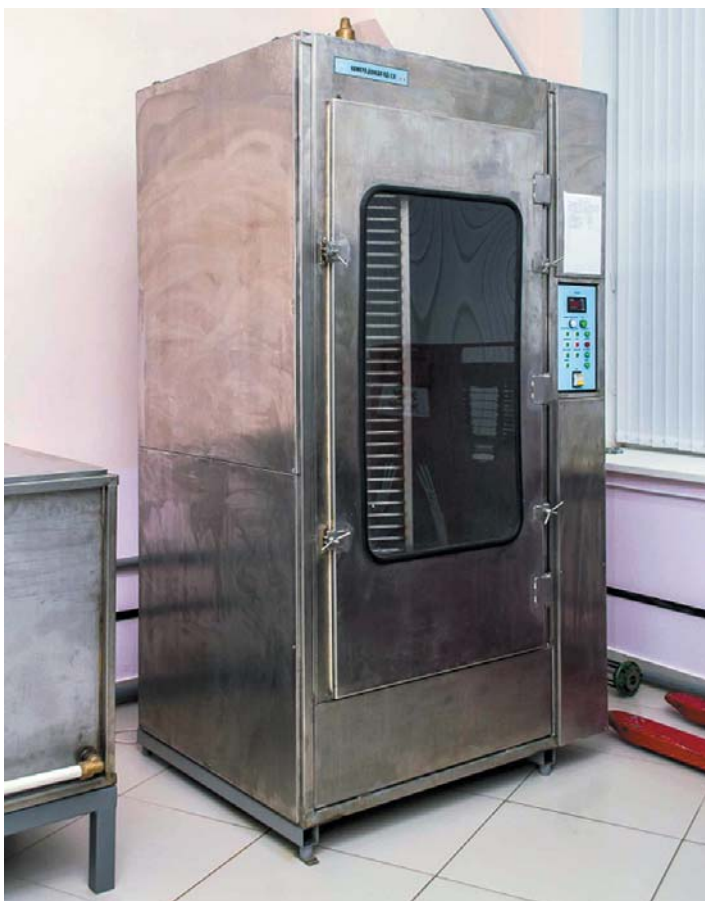
Рис. 1. Камера дождя КД-2,0
