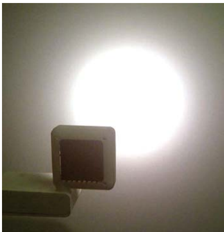
Рис. 9. а) Распределение света прожектора в виде проекции на поверхность; б) диаграмма измеренного светового распределения
