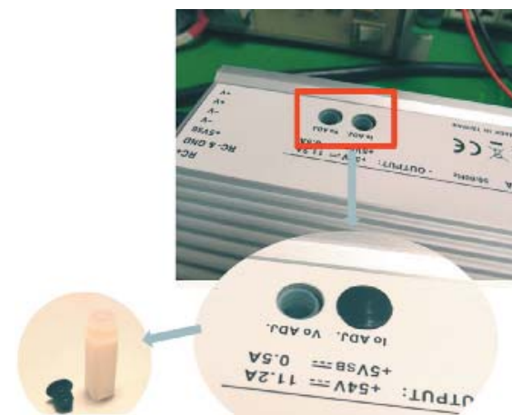
Рис. 2. Встроенные потенциометры ИП с защитой корпуса IP65
