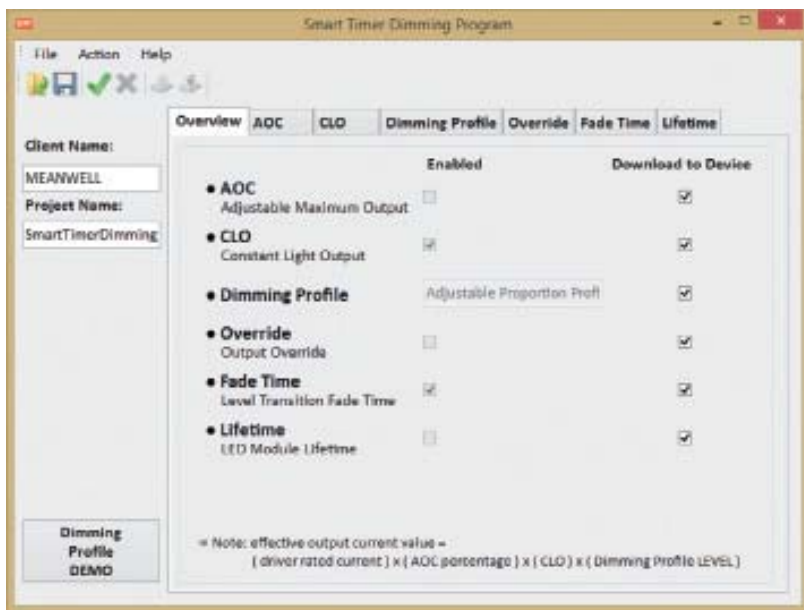
Рис. 7. Активация настроек для загрузки в память светодиодного драйвера
