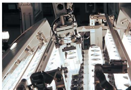
Рис. 12. Погрузка ламп в 5102
