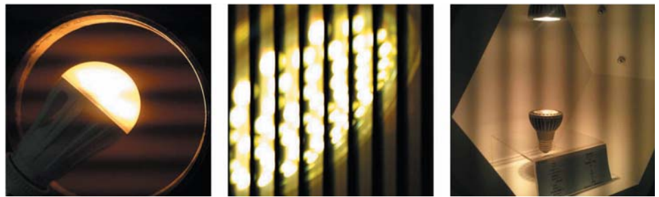
Рис. 5. Обнаружение пульсаций светового потока с помощью камеры мобильного телефона (снимки получены в лаборатории LAPLACE). Пульсации приводят к появлению на снимке темных полос
