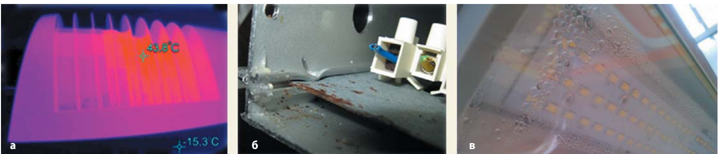
Рис. 2. Негативные эффекты, вызванные конденсатом в корпусе: а) разница температур в корпусе и на улице приводит к негативным перепадам давления; б) коррозия в корпусе; в) конденсат в светильнике
