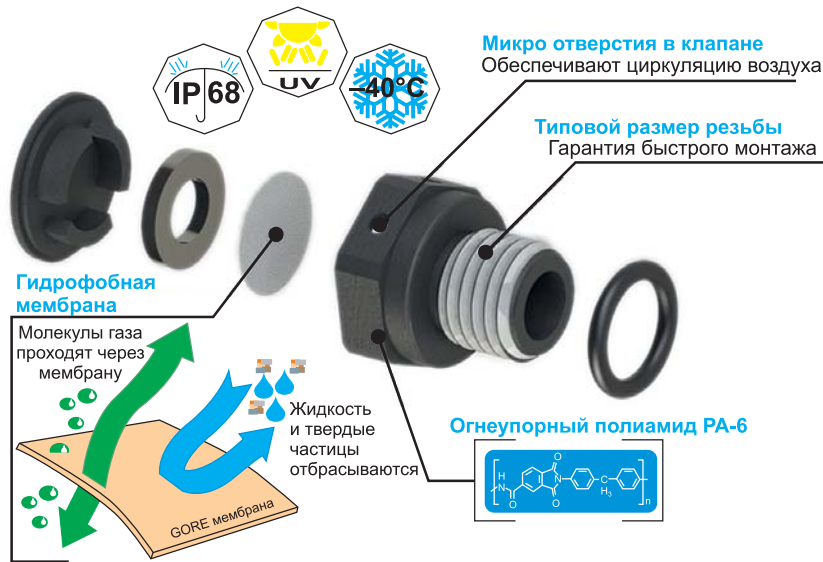
Рис. 6. Клапан выравнивания давления в разрезе
