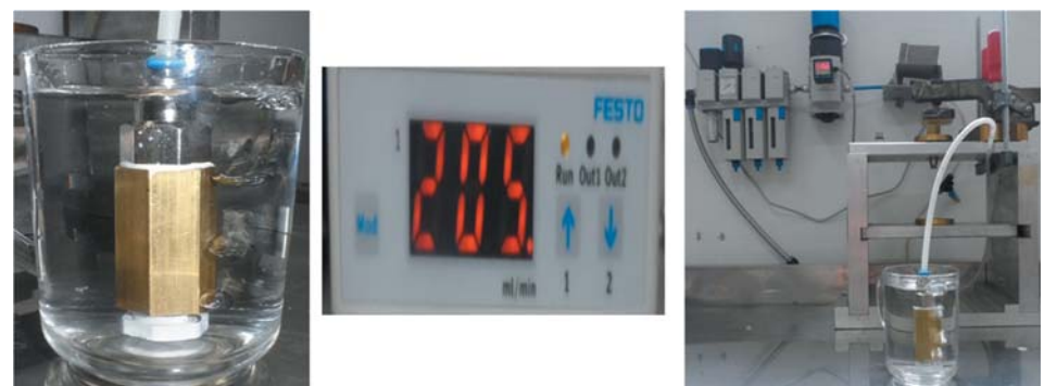
Рис. 9. Тестирование пропускной способности клапана выравнивания давления
