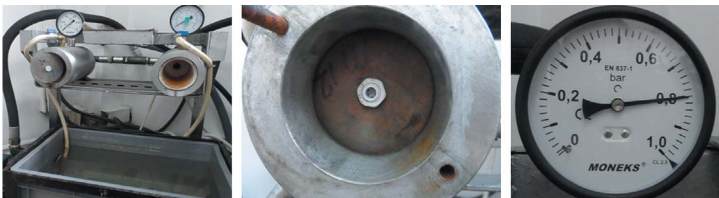
Рис. 10. Тестирование клапана на уровень защиты от окружающей среды (IP68)
