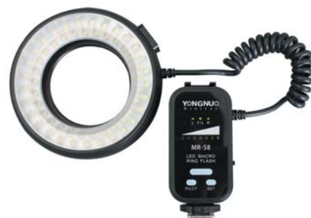
Рис. 9. Светодиодная кольцевая вспышка Yongnuo MR-58 для камер Canon, Nikon, Pentax, Olympus
