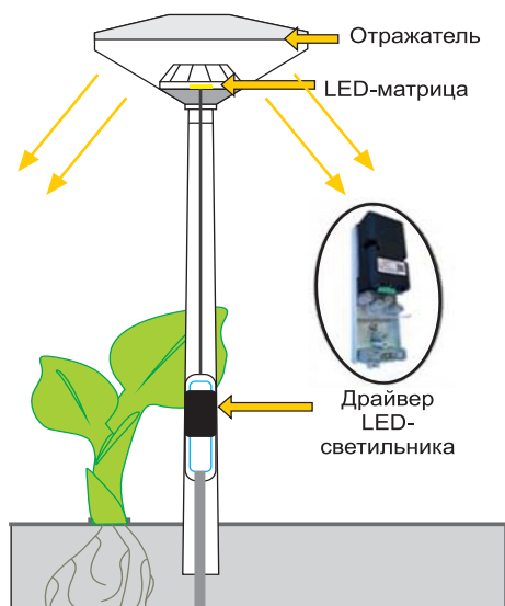
Рис. 8. Инновационное LED-освещение с размещением драйвера светильника в опоре
