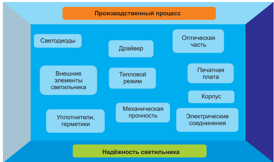
Рис. 1. Надёжность светодиодного светильника — производная надёжности всех составляющих: R_{\text{светильника}} = R_{\text{светодиода}} \times R_{\text{оптической части}} \times R_{\dots} \times R_{\dots} \times R_{\text{драйвер}}
